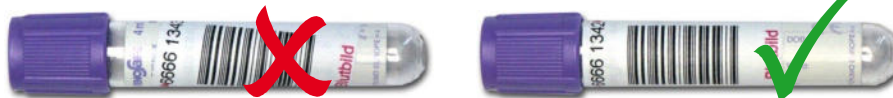
Die Barcode-Aufkleber müssen gerade und direkt am oberen Rand der Röhrchen aufgeklebt werden.
